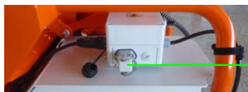
Abb. 10: Fernsteuerung anschließen
