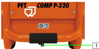
Εικόνα 6: Κλείσιμο βαλβίδας εκκένωσης
