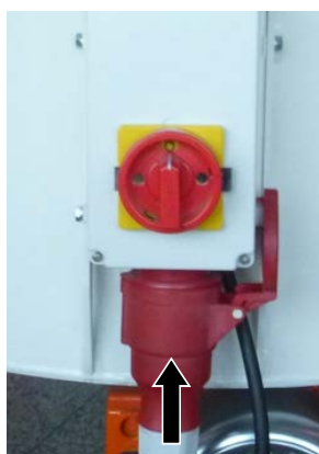
Figura 15: Collegamento all'alimentazione elettrica
