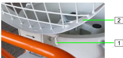
Figura 33: Apertura della griglia di protezione
