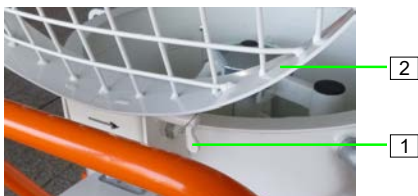
Figura 29: Apertura della griglia di protezione
