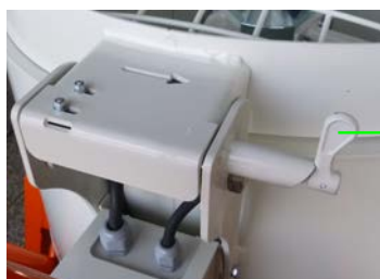
Figura 28: Apertura del fermo
