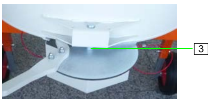
Figura 30: Pulizia della valvola a saracinesca
