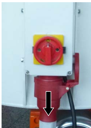
Figura 31: Staccare il cavo di allacciamento
