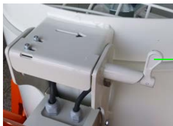
Figura 32: Lubrificazione del fermo
