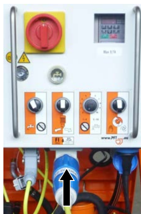
Figura 40: Collegamento all'alimentazione elettrica
