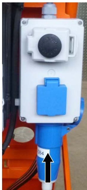
Figura 39: Collegamento all'alimentazione elettrica
