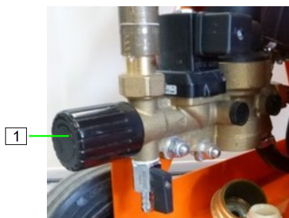
Figura 129: Valvola di riduzione della pressione
