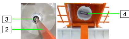
Figura 111: Sede dell'albero del pulitore
