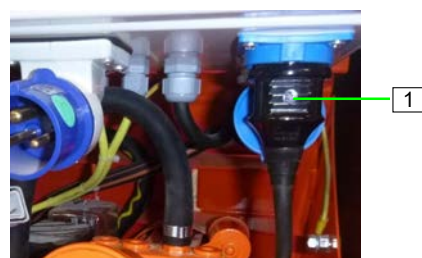
Figura 86: Tirare la spina di collegamento
