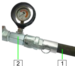
Figura 58: Collegare il tubo portamateriale
