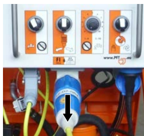
Figura 126: Staccare il cavo di alimentazione, quadro elettrico
