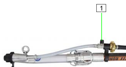
Figura 81: Chiudere il rubinetto dell'aria
