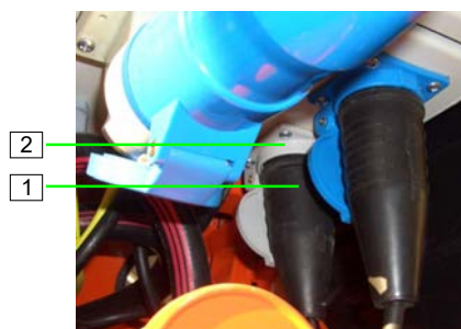
Figura 64: Collegare il vibratore
