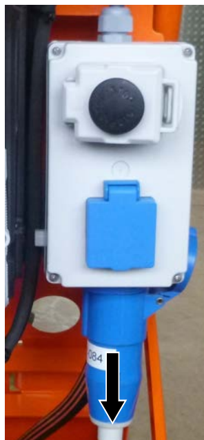
Figura 125: Staccare il cavo di alimentazione, set di cavi
