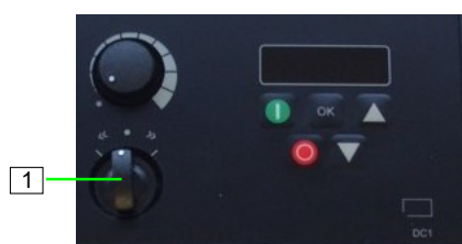
Figura 55: Immettere acqua nella zona di miscelazione
