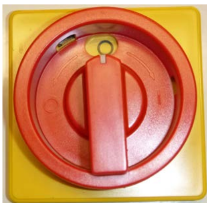
Figura 93: Interruttore principale in posizione «0»
