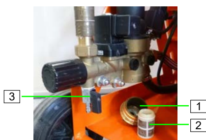
Figura 44: Controllare il filtro anti impurità
