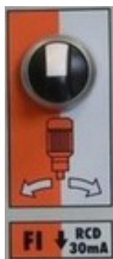
Figura 28: Selettore motore pompa
