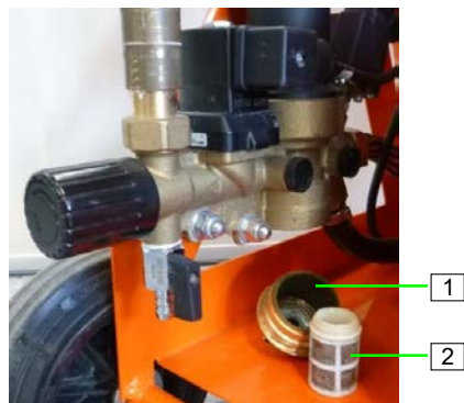
Figura 128: Filtro anti impurità nel riduttore di pressione
