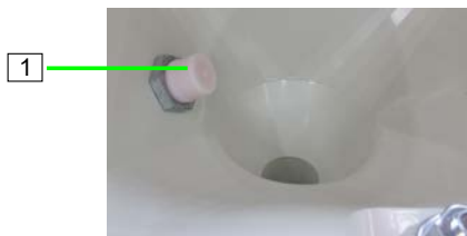
Abb. 1: Füllstandsonde im Materialbehälter
