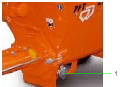
Εικόνα 28: Άνοιγμα του στομίου καθαρισμού
