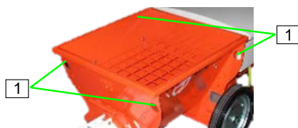
Εικόνα 5: Σημεία ανάρτησης μεταφοράς με γερανό
