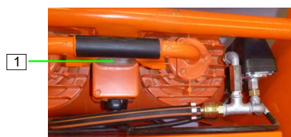
Εικόνα 34: Ενεργοποίηση του συμπιεστή αέρα
