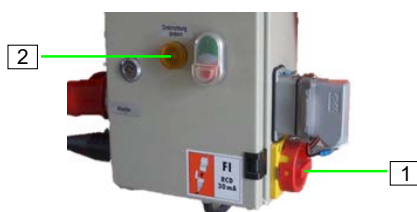
Figura 22: Verificați direcția de rotație
