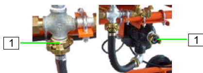
Figura 52: Sita de captare a murdăriei la admisia apei
