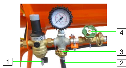
Figura 25: Racord alimentare cu apă fără pompă de creștere a presiunii
