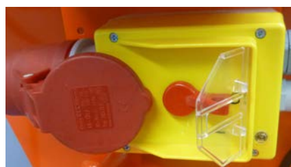
Figura 39: Invertor de fază pe poziția „0“
