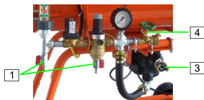
Figura 26: Racord alimentare cu apă cu pompă de creștere a presiunii
