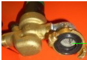
Figura 23: Verificarea sitei de reținere a impurităților
