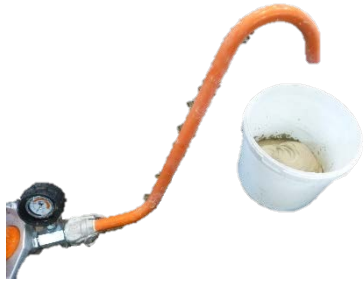
Afbeelding 71: Consistentiecontrolebuis
