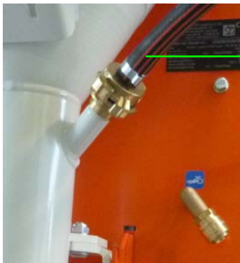
Afbeelding 118: Waterslang afkoppelen
