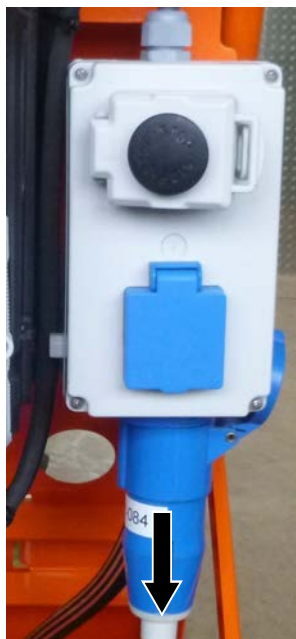
Afbeelding 125: Aansluitkabel verwijderen kabelset
