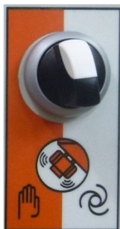
Afbeelding 31: Keuzeschakelaar schudder
