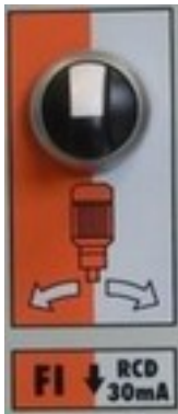
Afbeelding 28: Keuzeschakelaar van de pompmotor
