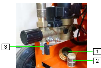
Afbeelding 44: Vuilvangzeef controleren
