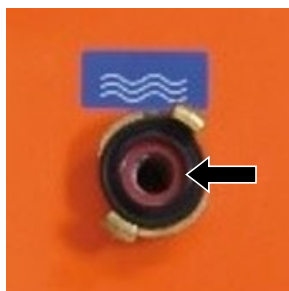
Afbeelding 127: Vuilvangzeef in de waterinloop
