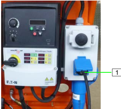
Afbeelding 85: Aansluitstekker eruit trekken
