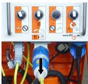
Afbeelding 126: Aansluitkabel verwijderen schakelkast
