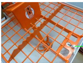
Afbeelding 6: Moer losdraaien
