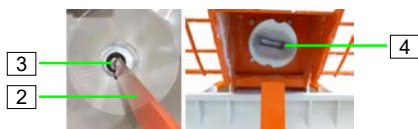
Afbeelding 111: Zitting van de reinigeras
