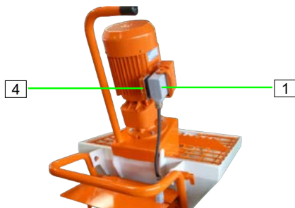
Afbeelding 108: Motoraansluitkabel verwijderen
