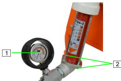
Afbeelding 121: Morteldruk controleren
