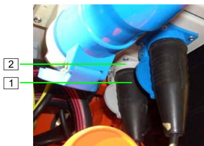
Afbeelding 66: Drukverhogingspomp aansluiten
