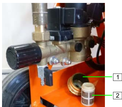
Afbeelding 128: Vuilvangzeef in drukreducerklep
