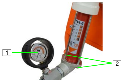
Afbeelding 94: Morteldruk controleren en afbouwen
