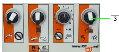
Afbeelding 67: Drukverhogingspomp inschakelen
