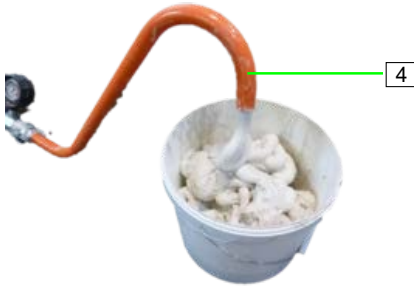
Afbeelding 75: Consistentie controleren
