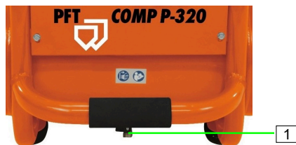
Figura 6: Închiderea supapei de evacuare
