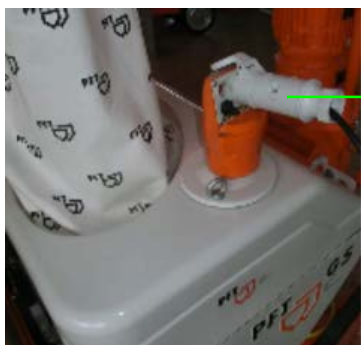
Figura 30: Estrazione della spina di comando
