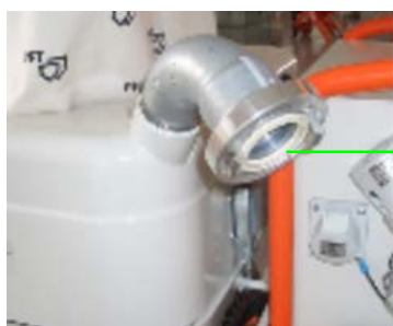
Figura 19: Collegamento del flessibile di alimentazione
