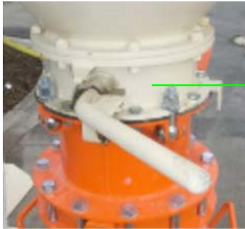
Figura 39: Chiudere lo sportello di uscita del silo
