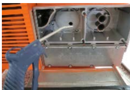
Figura 62: Pulire l'alloggiamento del filtro
