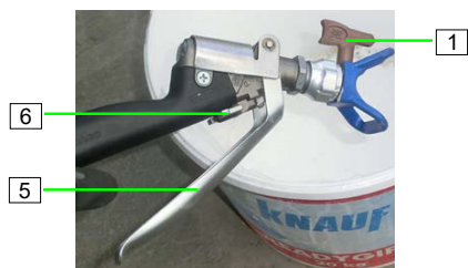
Фигура 76: Изплакване на машината и на маркучите за високо налягане
