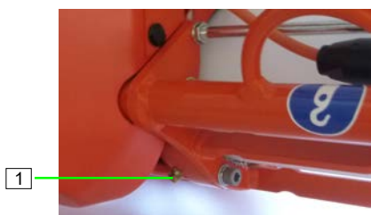
Фигура 103: Смазване на уплътняващия блок
