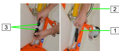
Фигура 99: Отстраняване на дръжката
