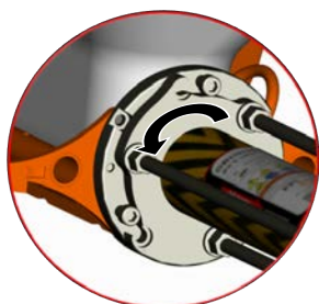
Фигура 101: Освобождаване на блока на помпата
