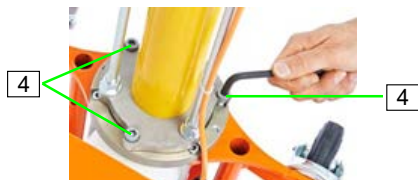
Ábra 100: Csavarok oldása
