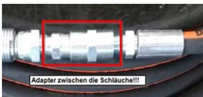
Ábra 35: Adapter a tömlők között
