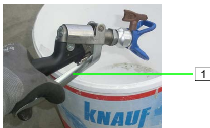
Ábra 60: A kioldókar működtetése
