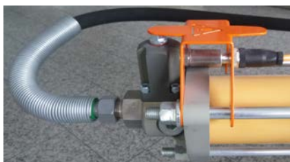
Ábra 24: Nyomásérzékelő
