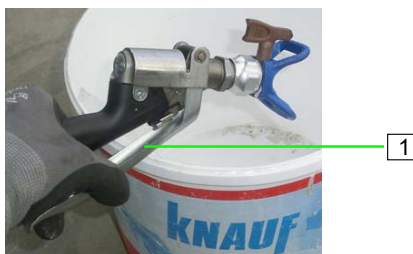
Obrázek 60: Ovládání spouštěcí páčky
