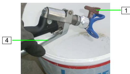
Obrázek 90: Čištění reverzní trysky
