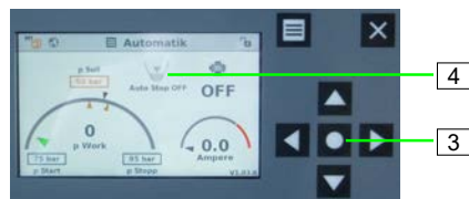
Obrázek 53: Deaktivace ochrany proti chodu naprázdno
