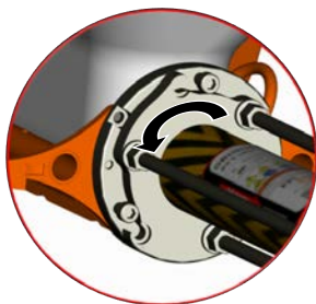
Obrázek 101: Uvolnění čerpací jednotky
