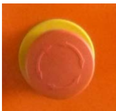
Obrázek 23: Tlačítko NOUZOVÉ ZASTAVENÍ / NOUZOVÉ VYPNUTÍ
