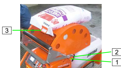
Obrázek 56: Montáž zařízení na vytlačování obsahu pytlů
