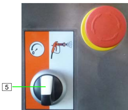
Obrázek 54: Předmazání čerpací jednotky
