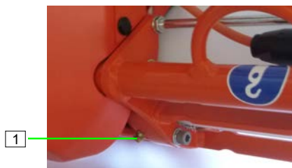
Obrázek 103: Promazání těsnicí jednotky
