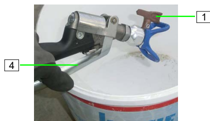
Figura 90: Limpie la boquilla de inversión
