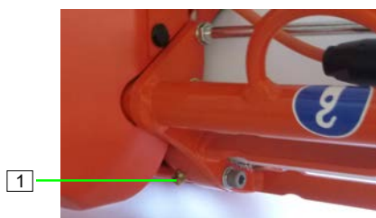
Figura 103: Lubricación de la unidad de sellado
