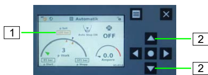
Figura 44: Ajuste la presión de conexión y desconexión
