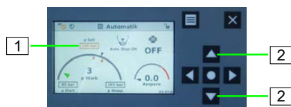
slika 44: Podešavanje pritiska uključivanja i isključivanja
