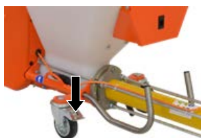
slika 30: Blokiraj točkić za fiksiranje
