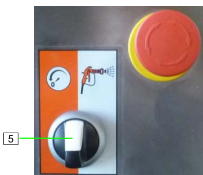
slika 54: Prethodno podmaži jedinicu pumpe
