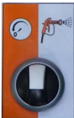
slika 18: Prekidač za izbor rada motora pumpe
