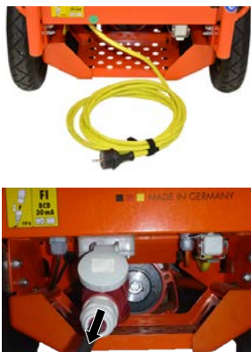
slika 94: Uklanjanje priključnog kabl
