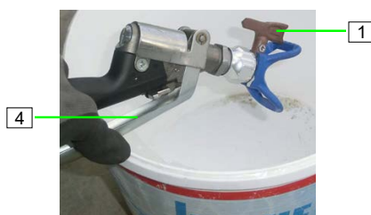
slika 90: Očisti mlaznicu za obrtanje
