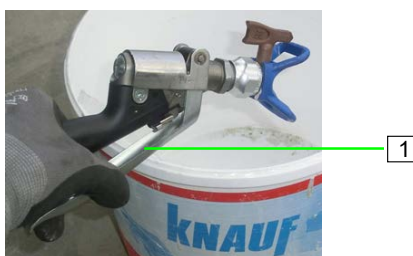
Figura 60: Acționarea manetei de tragere
