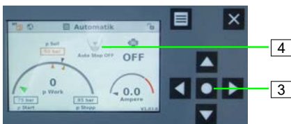
Figura 53: Dezactivarea protecției împotriva funcționării în gol
