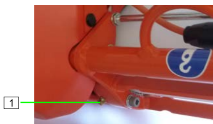
Figura 103: Lubrificați unitatea de etanșare
