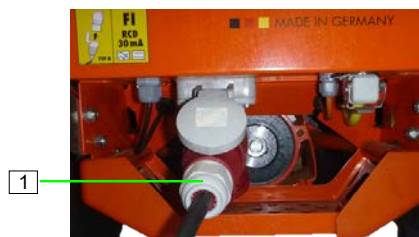
Figura 32: Racordați tensiunea de alimentare
