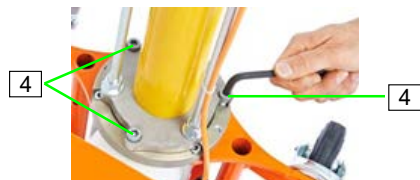
Figura 100: Desfăcerea șuruburilor
