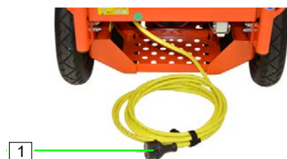
Figura 31: Racordați tensiunea de alimentare
