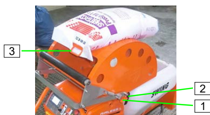
Figura 56: Montarea calandrului de sac
