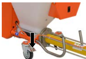
Figura 30: Blocați rola de fixare
