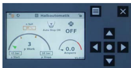
Figura 21: Mod de funcționare semiautomat
