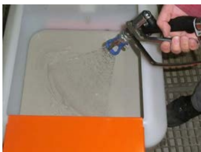
Figura 61: Orientarea pistolului de aplicat prin stropire în rezervorul de material
