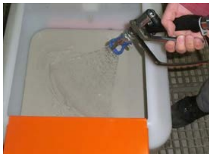
ilustracja 61: Skierowanie pistoletu natryskowego do zbiornika materiału
