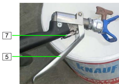
ilustracja 75: Spuszczenie ciśnienia
