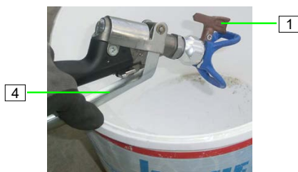
ilustracja 90: Wyczyszczenie dyszy odwracalnej
