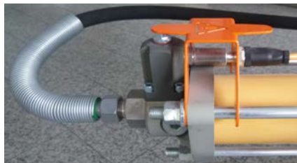
ilustracja 24: Czujnik ciśnienia
