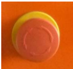
ilustracja 23: Przycisk ZATRZYMANIA AWARYJNEGO / WYŁĄCZNIKA AWARYJNEGO
