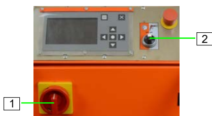
ilustracja 72: Włączanie maszyny po zaniku zasilania
