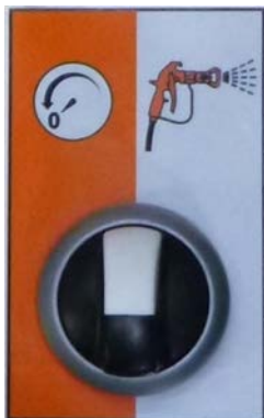
ilustracja 18: Przełącznik silnika napędowego pompy
