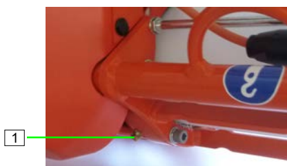
ilustracja 103: Przesmarować jednostkę uszczelniającą
