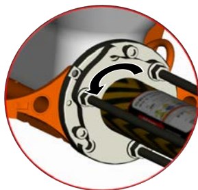
ilustracja 101: Odłączenie zespołu pompy
