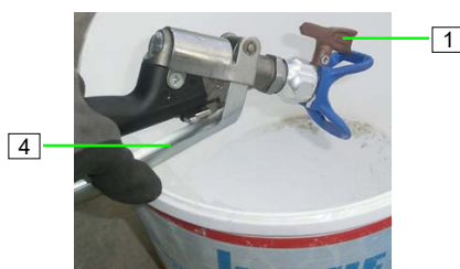
Afbeelding 90: Omkeermondstuk reinigen
