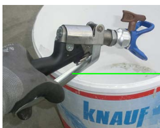
Afbeelding 60: Activeringshendel bedienen
