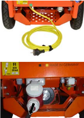
Afbeelding 94: Aansluitkabel verwijderen
