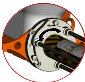
Afbeelding 101: Pompunit verwijderen
