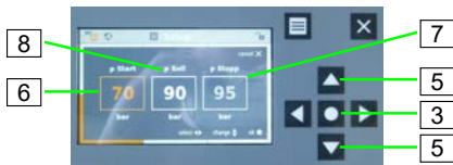
Afbeelding 44: De in- en uitschakeldruk instellen
