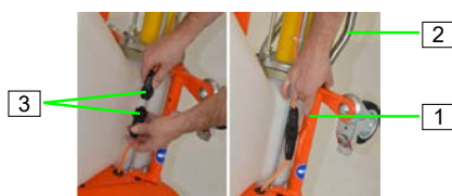
Afbeelding 99: Greep verwijderen
