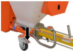
Afbeelding 30: Zwenkwieken vergrendelen
