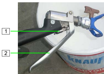
Afbeelding 59: De veiligheidshendel omzetten
