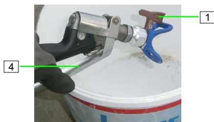
Att. 90: Apgriežamās sprauslas tīrīšana
