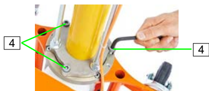
Att. 100: Skrūvju atskrūvēšana
