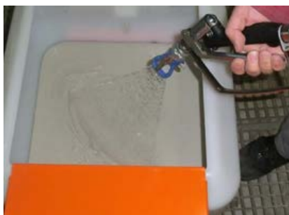
Att. 61: Pavērsiet izsmidzināšanas pistoli uz materiāla tvertni
