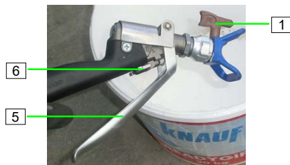
Att. 76: Iekārtas un augstspiediena šļūteņu skalošana
