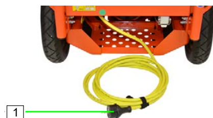
Att. 31: Elektroapgādes pieslēgšana
