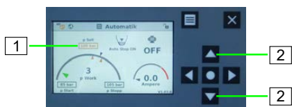
Att. 44: Ieslēgšanās un izslēgšanās spiediena iestatīšana
