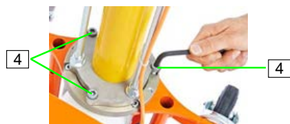
slika 100: Otpuštanje vijaka
