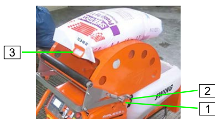
slika 56: Postavljanje stiskača vreće
