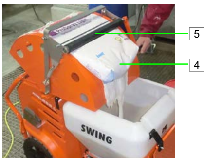
slika 57: Pražnjenje stiskača vreće
