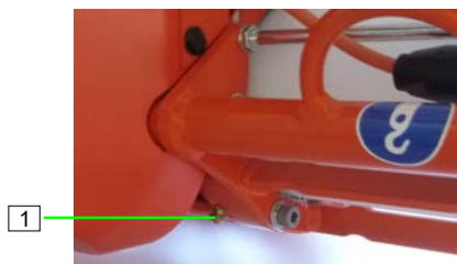
slika 103: Podmazivanje jedinice za brtvljenje
