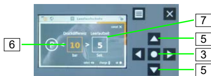
slika 49: Namještanje razlike tlaka i vremena rada na suho
