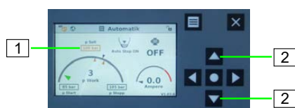
Figura 44: Impostare la pressione di accensione e spegnimento
