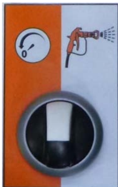
Figura 18: Selettore motore pompa
