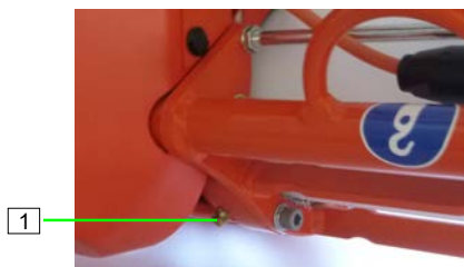
Figura 103: Lubrificare il gruppo di tenuta
