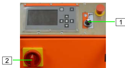
Figura 38: Accendere la macchina
