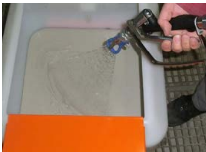
Figura 61: Indirizzare la pistola spruzzatrice nella tramoggia
