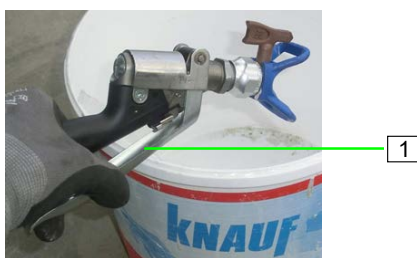
Figura 60: Azionare la leva del grilletto
