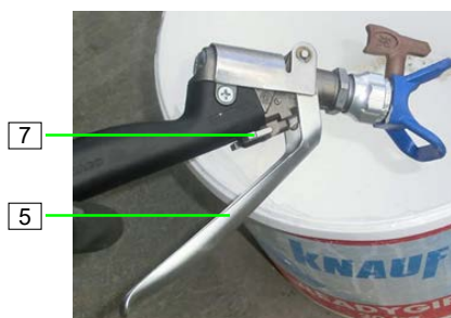
Figura 75: Scaricare la pressione
