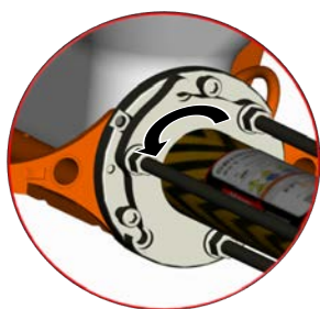
Figura 101: Staccare il gruppo pompa
