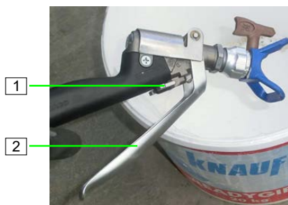
Figura 59: Ribaltare la leva di sicurezza
