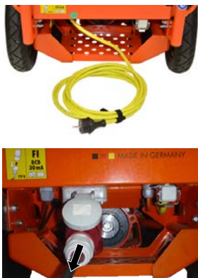
Figura 94: Staccare il cavo di allacciamento
