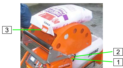
Figura 56: Montare lo spremisacchi
