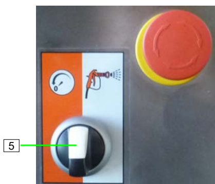
Figura 54: Prelubrificare il gruppo pompa
