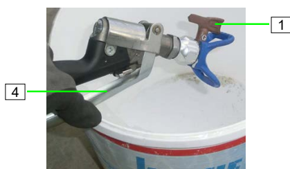
Figura 90: Pulire l'ugello reversibile
