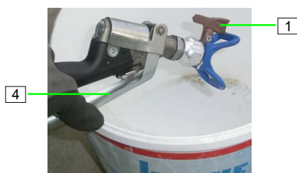
Figure 90 : Nettoyer la buse d'inversion
