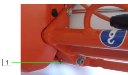
Figure 103 : Lubrification de l'unité d'étanchéité
