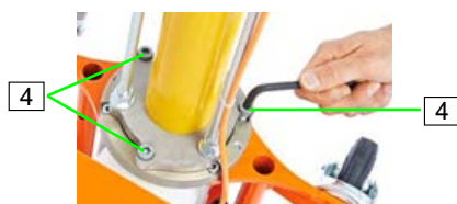
Figure 100 : Retrait des vis
