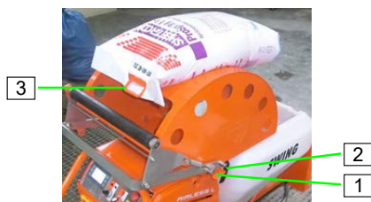
Figure 56 : Montage du vide-sac
