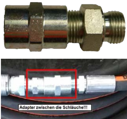
Abb. 35: Adapter zwischen den Schläuchen
