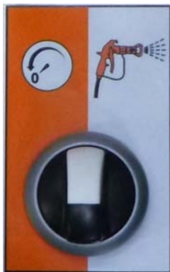
Abb. 18: Wahlschalter Pumpenmotor
