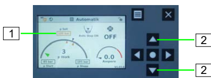
Abb. 44: Einschalt - und Abschaltdruck einstellen
