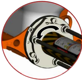
Abb. 101: Pumpeneinheit lösen
