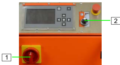
Abb. 72: Maschine nach Stromausfall einschalten
