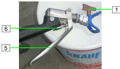
Abb. 76: Maschine und Hochdruckschläuche spülen
