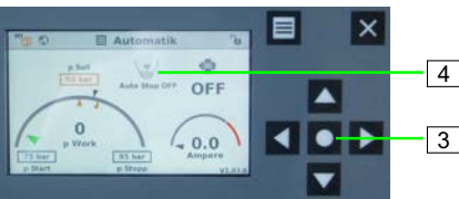
Abb. 53: Leerlaufschutz deaktivieren
