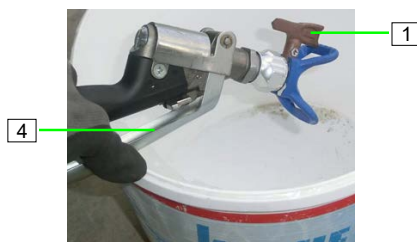
Abb. 90: Umkehrdüse reinigen
