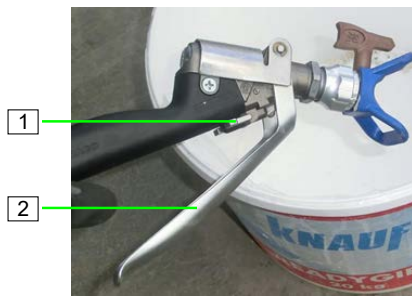
Abb. 59: Sicherungshebel umlegen
