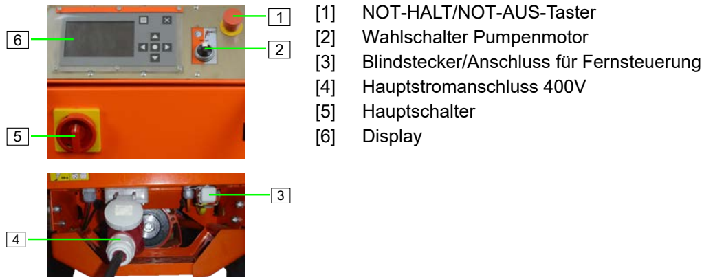
Abb. 15: Baugruppe Schaltschrank
