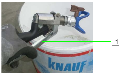
Abb. 60: Abzugshebel betätigen
