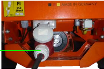
Abb. 32: Stromversorgung anschließen
