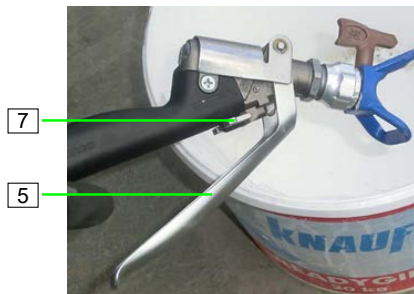
Abb. 75: Druck ablassen
