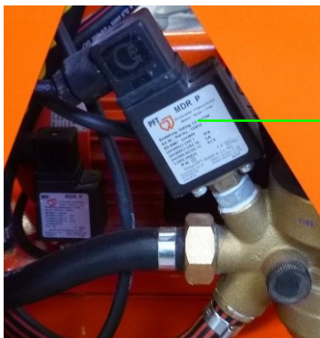
Abb. 130: Druckschalter
