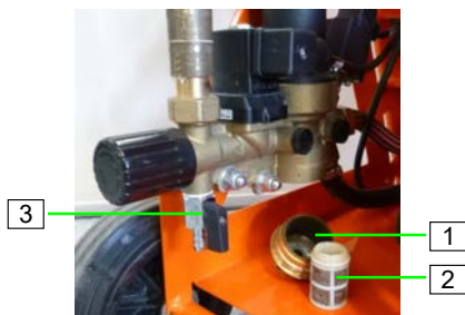
Abb. 44: Schmutzfängersieb prüfen
