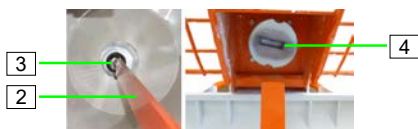
Abb. 111: Sitz der Reinigerwelle
