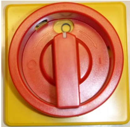
Abb. 93: Hauptschalter auf Stellung "0"
