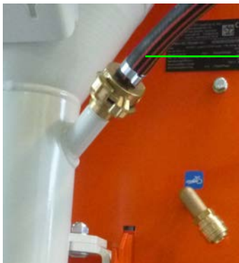
Abb. 118: Wasserschlauch abkuppeln
