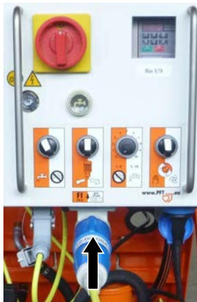
Abb. 40: Stromversorgung anschließen
