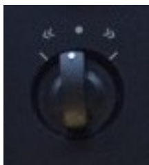
Abb. 26: Wahlschalter Pumpenmotor
