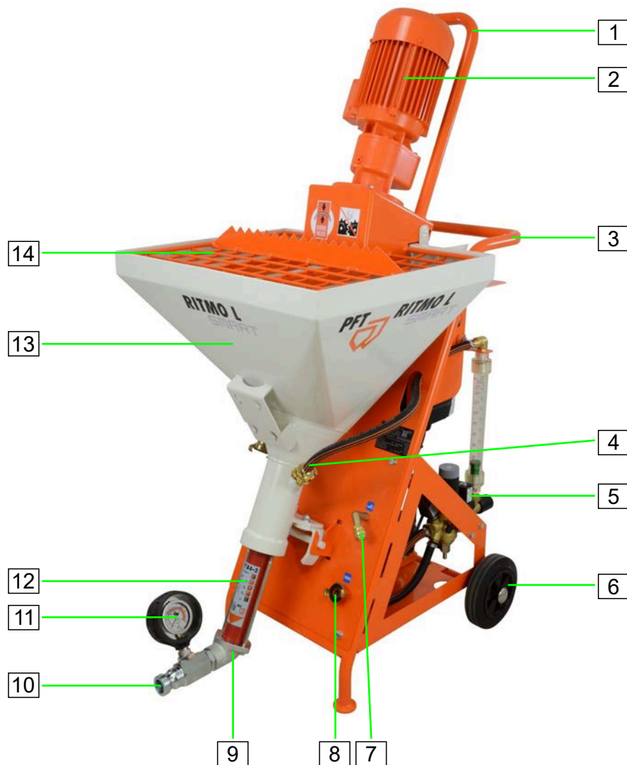
Abb. 10: Übersicht über die Baugruppen
