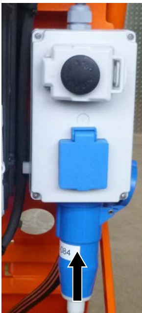
Abb. 39: Stromversorgung anschließen
