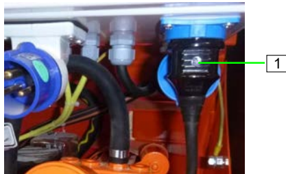
Abb. 86: Anschlussstecker ziehen
