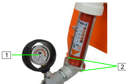
Abb. 94: Mörteldruck überprüfen und ablassen
