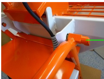
Abb. 7: Drehriegel öffnen
