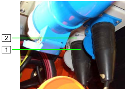
Abb. 64: Rüttler anschließen
