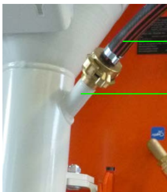
Abb. 89: Blinddeckel verschließen
