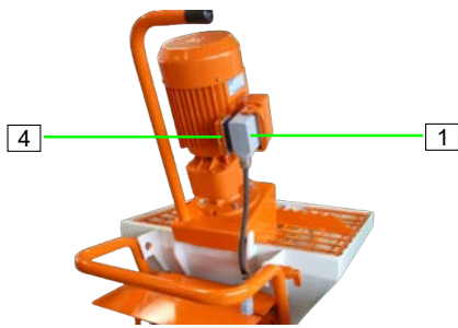
Abb. 108: Motoranschlusskabel entfernen
