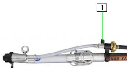
Abb. 81: Lufthahn schließen
