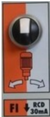
Abb. 28: Wahlschalter Pumpenmotor
