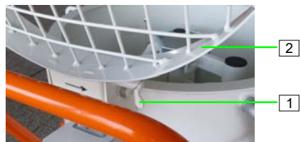
Εικόνα 29: Άνοιγμα της προστατευτικής σχάρας
