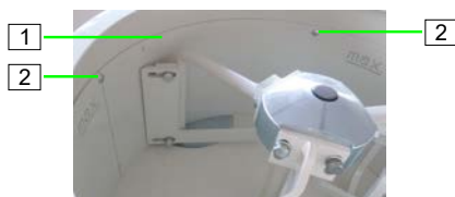
Εικόνα 36: Αντικατάσταση ελάσματος θωράκισης
