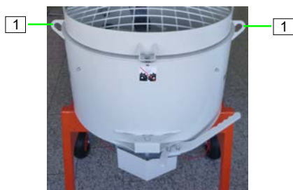
Εικόνα 5: Σημεία ανάρτησης
