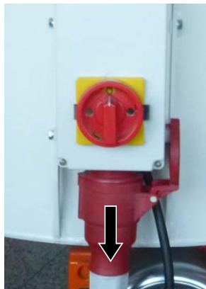
Εικόνα 31: Αφαίρεση καλωδίου σύνδεσης
