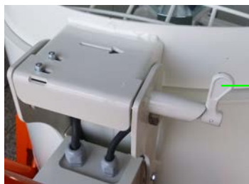
Εικόνα 32: Λίπανση περιστροφικού κλείστρου
