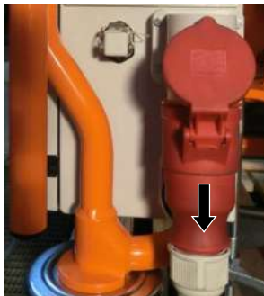
Ábra 82: A csatlakozókábel eltávolítása
