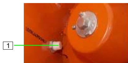
Ábra 24: Szintmérő szonda az anyagtartályban
