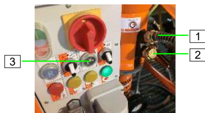
Ábra 38: A keverőzóna vízzel való feltöltése
