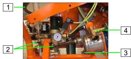
Ábra 62: A vízellátás leválasztása
