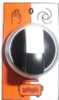
Ábra 19: Nyomásfokozó szivattyú választókapcsolója
