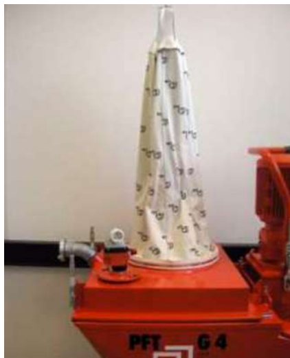
Ábra 47: Befúvó fedél
