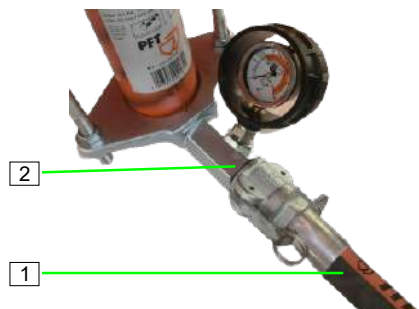
Ábra 40: A habarcstömlő csatlakoztatása
