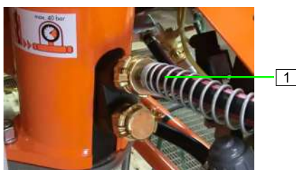
Ábra 71: Vízcsatlakozás rákötése
