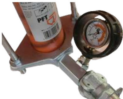
Ábra 26: Habarcsnyomásmérő
