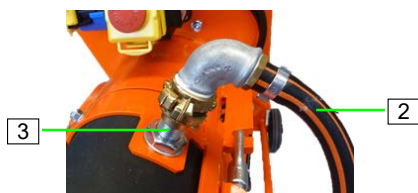
Ábra 36: A vízellátás leválasztása
