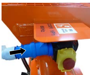
Ábra 17: Áramellátás csatlakoztatása
