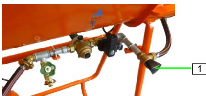
Ábra 25: A vízmennyiség beállítása
