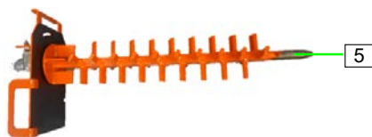
Ábra 40: Csapágycsap zsírzása
