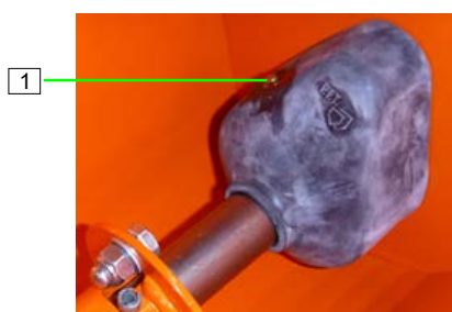
Ábra 48: Csapágycsapó kenése
