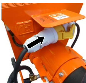
Ábra 18: Áramellátás csatlakoztatása
