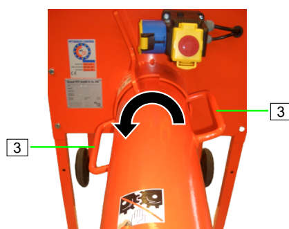
Figura 39: Rimozione del tubo di miscelazione
