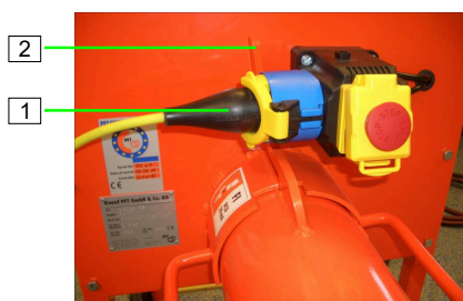
Figure 38 : Retrait du câble de raccordement
