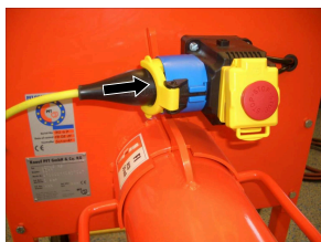
Figure 22 : Raccorder l'alimentation électrique
