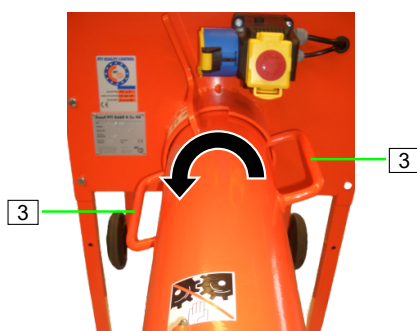
Figure 39 : Retirer le tube de mélange
