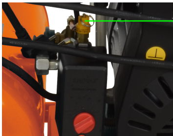
Abb. 5: Sicherheitsventil
