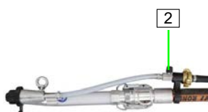
Obrázek 45: Otevření vzduchového kohoutu
