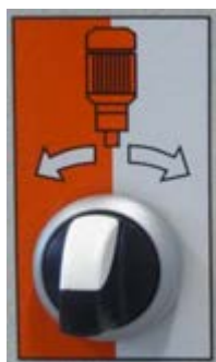
Obrázek 14: Přepínač motoru čerpadla
