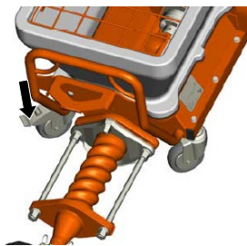
Obrázek 20: Zajistěte pojezdové kolečko blokováním
