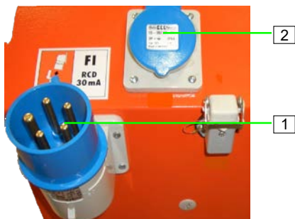
Obrázek 22: Připojení napájecího zdroje
