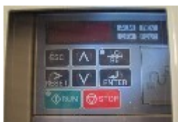
Obrázek 68: Ukazatel poruchy frekvenčního měniče
