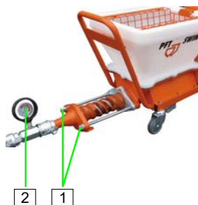
Obrázek 71: Zkontrolujte a snižte tlak malty
