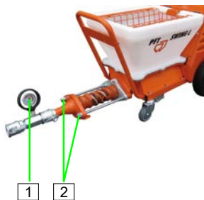
Obrázek 56: Zkontrolujte a snižte tlak malty
