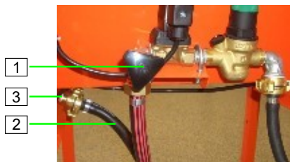
ilustracja 30: Regulacja natężenia przepływu wody
