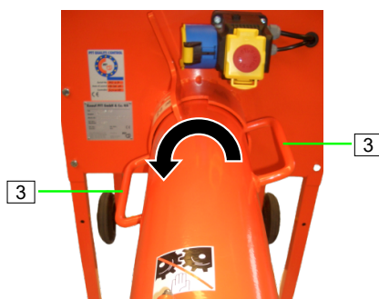
ilustracja 39: Demontaż rury mieszalnej
