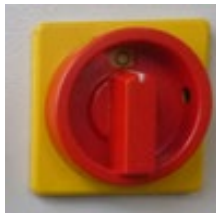
Abb. 59: Hauptschalter auf Stellung „0“
