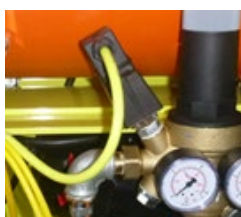
Abb. 89: Druckschalter Wasser
