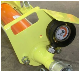
Abb. 36: Mörteldruckmanometer
