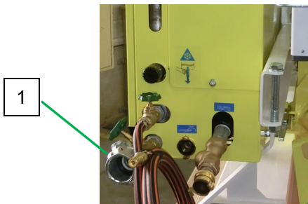
Abb. 43: Mörtelschlauch vorbereiten
