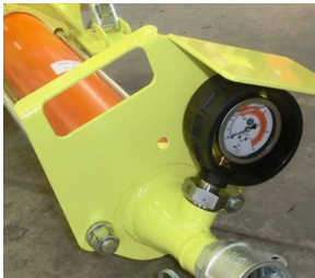
Abb. 20: Mörteldruckmanometer
