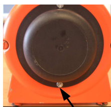
Abb. 87: Öffnung Filterabdeckung
