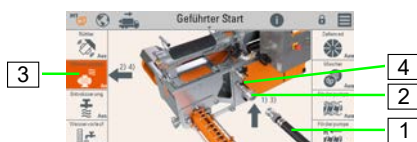
Abb. 49: Mörtelschläuche wässern
