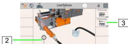
Abb. 83: Mörteldruck ablassen
