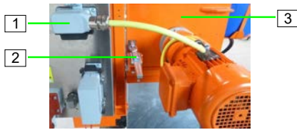
Abb. 93: Motorflansch öffnen
