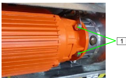
Abb. 126: Pumpenmotor wechseln
