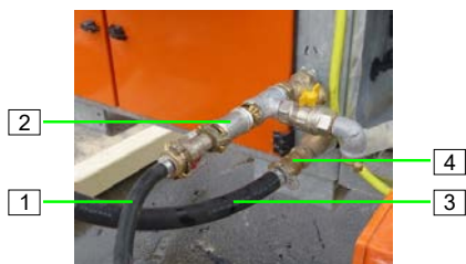
Abb. 76: Wasserschläuche abkuppeln
