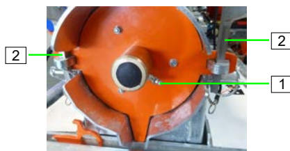
Abb. 132: Außenlager Mischrohr abschmieren
