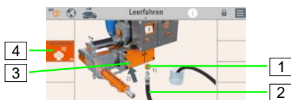
Abb. 84: Mörtelschlauch reinigen
