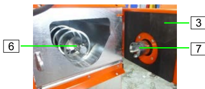
Abb. 95: Mischer reinigen
