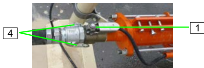
Abb. 82: Mörtelschlauch abkuppeln
