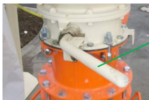
Abb. 35: Siloauslaufklappe schließen
