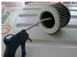
Abb. 46: Filterpatronen reinigen
