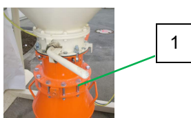
Abb. 10: Fördergefäß anschließen
