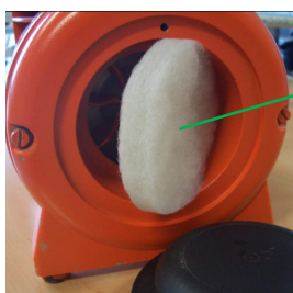
Abb. 49: Filter des Kompressors
