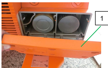
Abb. 44: Filterdeckel lösen
