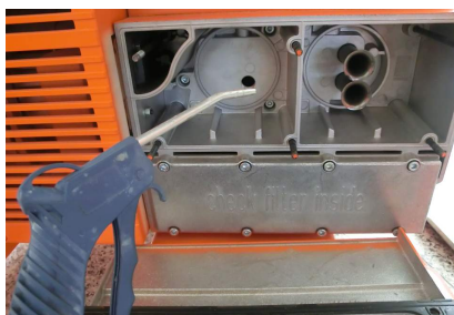
Abb. 47: Filtergehäuse reinigen
