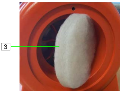
Abb. 109: Filter Luftkompressor
