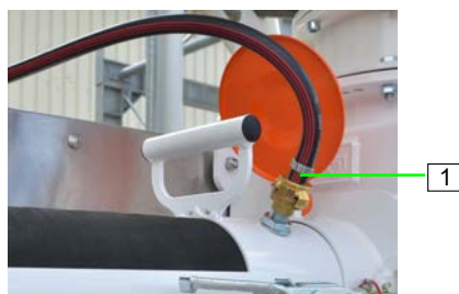
Abb. 81: Wasserschlauch abkuppeln
