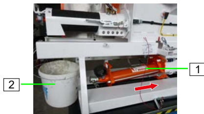
Abb. 48: Pumpenbehälter verschieben
