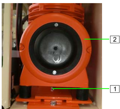
Abb. 108: Luftkompressor herausnehmen
