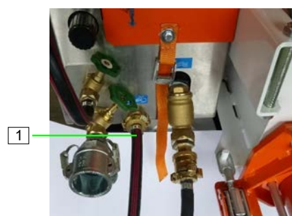
Abb. 58: Luftschlauch anschließen
