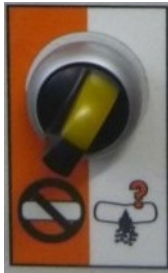
Abb. 17: Wahlschalter Füllstandsonde
