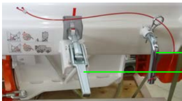
Abb. 52: Pumpeneinheit lösen
