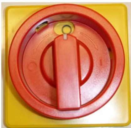
Abb. 77: Hauptschalter auf Stellung "0"
