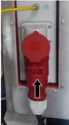
Abb. 37: Stromversorgung anschließen
