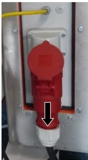
Abb. 105: Anschlusskabel entfernen
