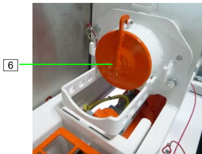
Abb. 91: Mischrohrabdeckung schließen
