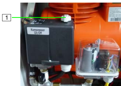
Abb. 67: Luftkompressor ausschalten
