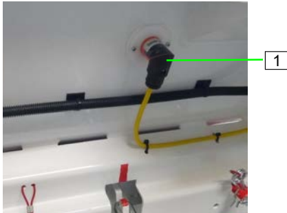
Abb. 33: Füllstandsonde im Mischer
