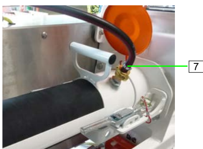
Abb. 46: Wasserschlauch anschließen
