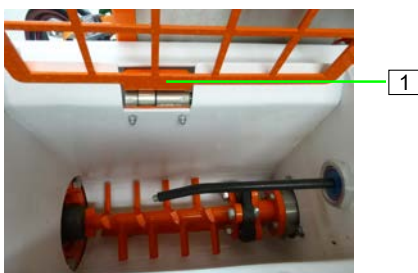
Abb. 32: Scharniersicherheitsschalter
