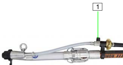
Abb. 72: Lufthahn schließen
