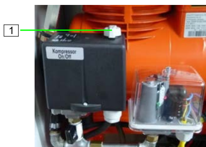
Abb. 74: Luftkompressor ausschalten
