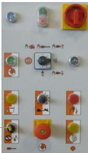
Abb. 34: Füllstandsonde deaktivieren
