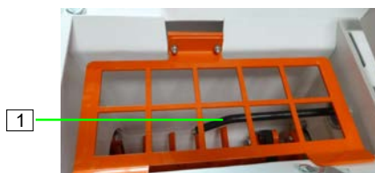
Abb. 94: Füllstandsonde reinigen
