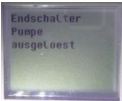
Abb. 99: Störung Endschalter Pumpeneinheit
