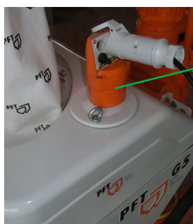
Σχ. 37: Αποσύνδεση βύσματος ελέγχου
