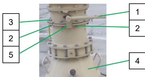
Σχ. 39: Αφαίρεση δοχείου μεταφοράς
