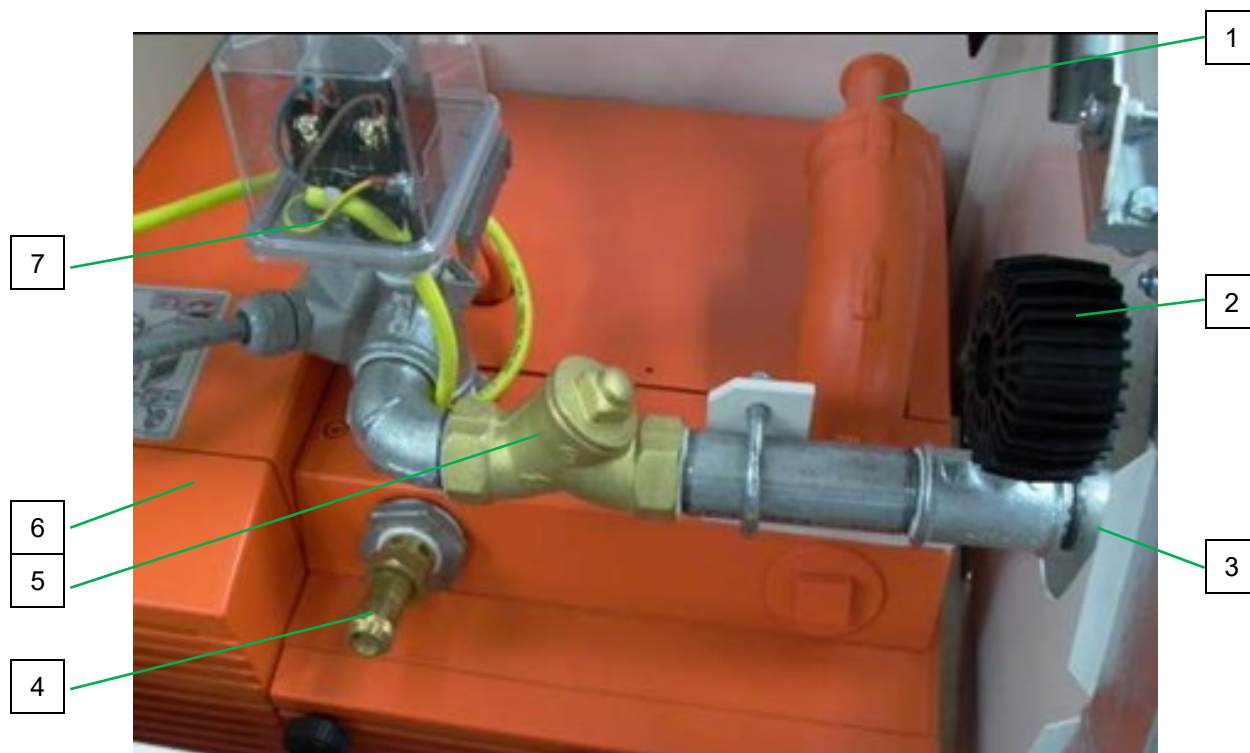
Σχ. 6: Επισκόπηση περιστροφικού συμπιεστή / συστήματος ελέγχου πίεσης
