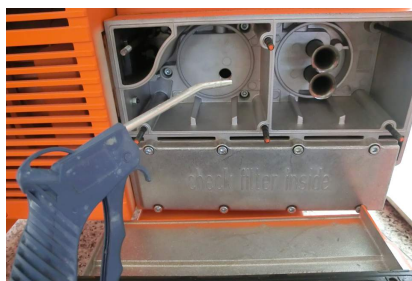
Σχ. 54: Καθαρισμός περιβλήματος φίλτρου
