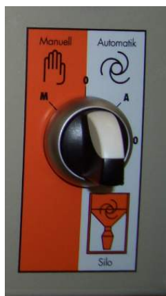
Σχ. 11: Τρόποι λειτουργίας περιστροφικού συμπιεστή
