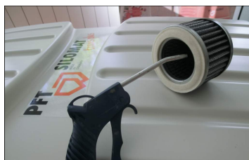
Фиг. 53: Почистване на филтърните патрони
