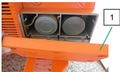
Фиг. 51: Отваряне на капака на филтъра
