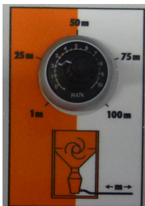
Фиг. 26: Настройване на разстоянието на подаване
