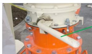
Фиг. 40: Затваряне на клапата за изпразване на силоса
