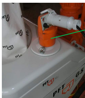
Фиг. 37: Откачане на контакта за управление
