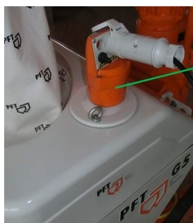
Fig. 37: Trageți ștecherul de comandă
