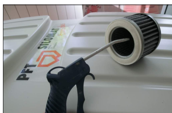
Fig. 53: Curățați cartusul filtrului
