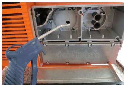
Fig. 54: Curățați carcasa filtrului
