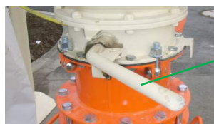
Fig. 40: Închideți clapeta de scurgere a magaziei
