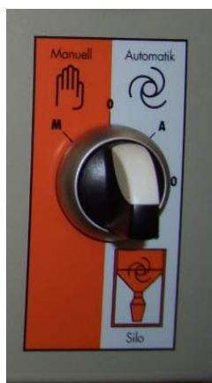
Sl. 11: načini rada rotacijskog kompresora
