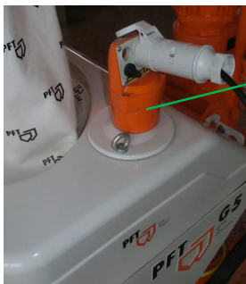
Sl. 37: izvlačenje upravljačkog utikača
