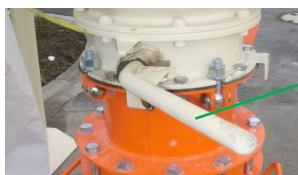
Sl. 40: zatvaranje izlazne zaklopke silosa
