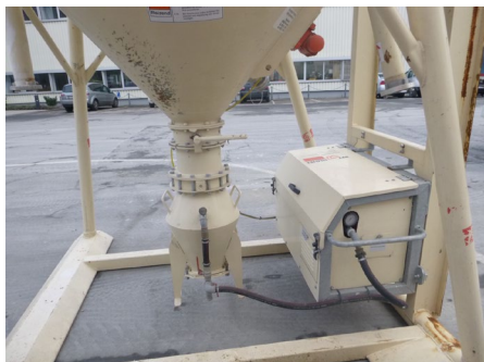
Sl. 14: postavljanje uređaja SILOJET
