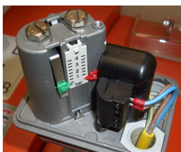
Sl. 60: tlačna sklopka
