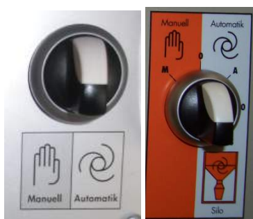
Sl. 61: sklopka ručno – „0“ – automatski
