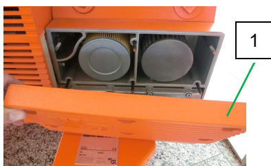
Sl. 51: otpuštanje poklopca filtra
