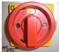
Sl. 57: glavna sklopka za promjenu smjera
