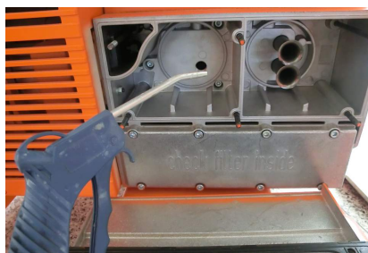
Sl. 54: čišćenje kućišta filtra
