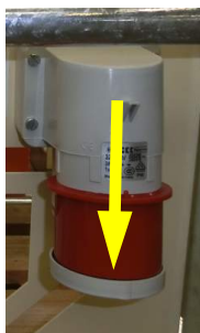
Sl. 50: prekid dovoda struje
