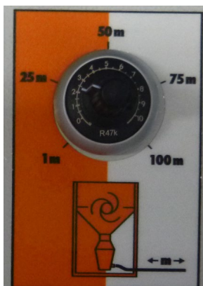
Sl. 26: namještanje duljine transporta
