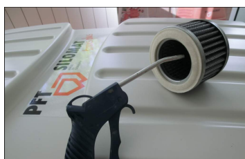
Рис. 53: Очистка фильтрующих элементов
