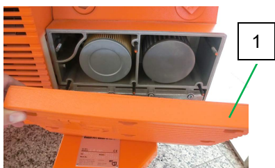
Рис. 51: Откручивание крышки фильтра
