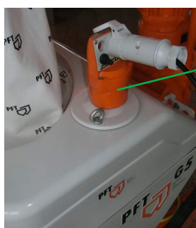
Рис. 37: Вытащить управляющий разъём
