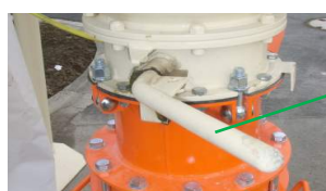
Рис. 40: Закрытие выпускной заслонки бункера
