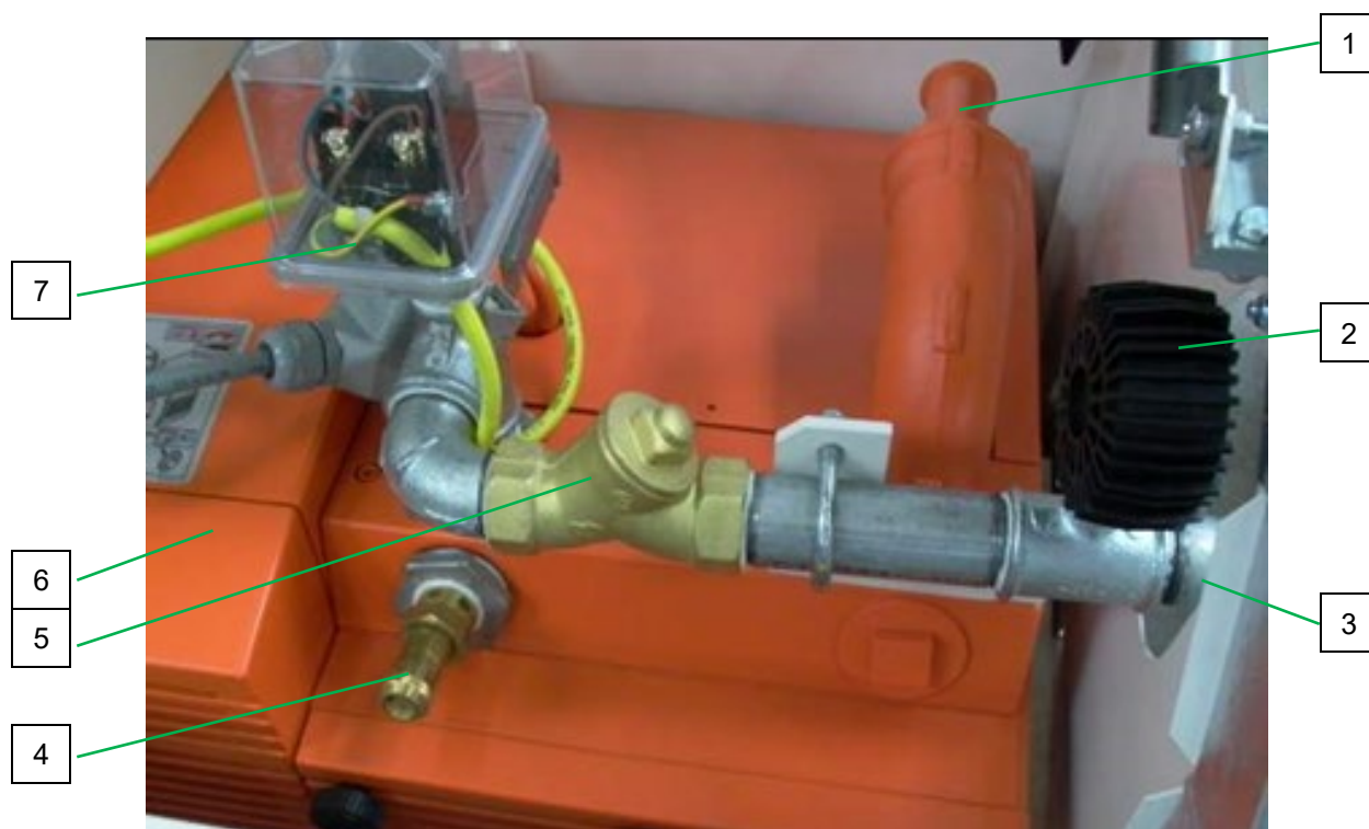
Рис. 6: Обзор ротационного компрессора / системы управления давлением
