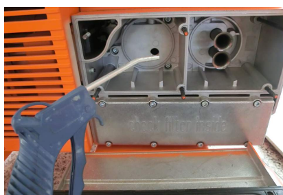
Рис. 54: Очистка корпуса фильтра.
