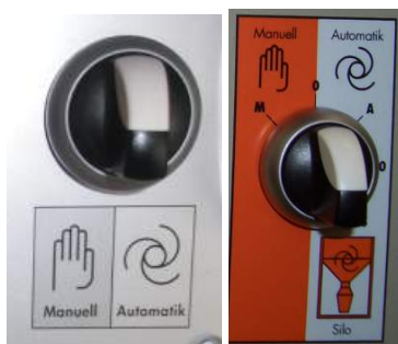
Рис. 61: Переключатель «Ручной» – «0» – «Автоматический»
