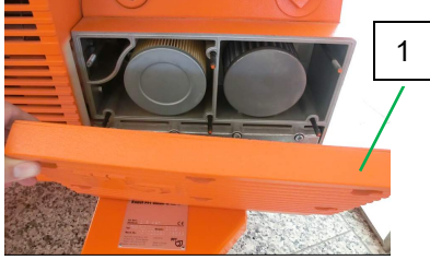
Res. 51: Filtre kapağının çözülmesi
