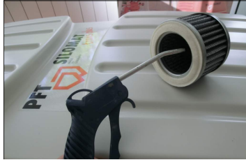
Res. 53: Filtre kartuşlarının temizlenmesi
