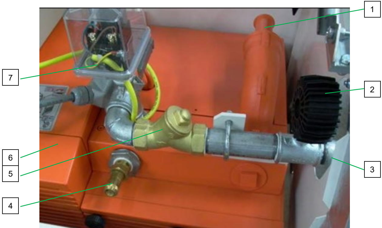
Res. 6: Döner kompresöre / Basınç kumanda ünitesine genel bakış
