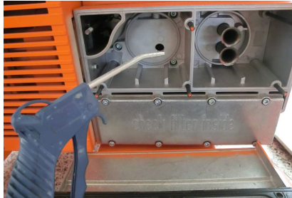
Res. 54: Filtre gövdesinin temizlenmesi
