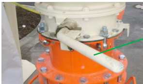
Res. 40: Silo çıkış klapesinin kapatılması
