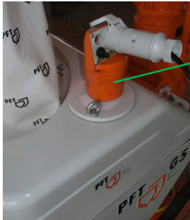
Res. 37: Kontrol soketinin çekilmesi
