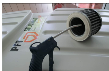
Illustration 53 : Nettoyer les cartouches filtrantes
