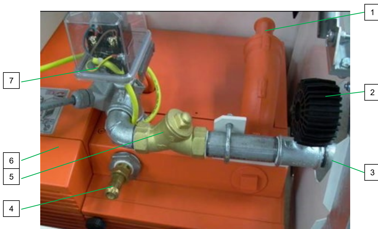
Illustration 6 : Vue d'ensemble du compresseur rotatif / de la commande de pression
