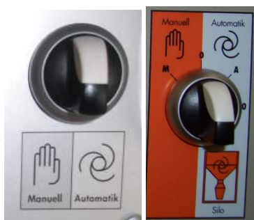
Illustration 61 : Commutateur Manuel – « 0 » – Automatique
