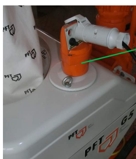
Illustration 37 : Retirer la prise de commande
