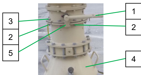
Illustration 39 : Retirer le récipient d'alimentation
