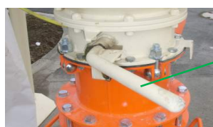
Illustration 40 : Fermer le clapet de la sortie du silo
