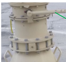
Illustration 33 : Fermer le clapet de la sortie du silo
