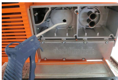
Illustration 54 : Nettoyer le boîtier du filtre
