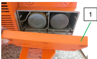
Illustration 51 : Desserrer le couvercle du filtre
