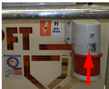
Illustration 15 : Raccordement de l'alimentation électrique
