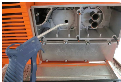
Fig. 54: Pulizia dell'alloggiamento del filtro
