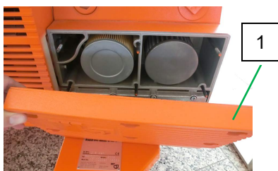
Fig. 51: Rimozione del coperchio del filtro
