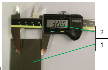
Fig. 55: Controllo della larghezza della saracinesca KDT 3.140
