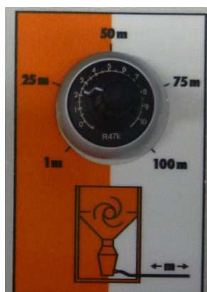
Fig. 26: Impostazione della portata di pompaggio
