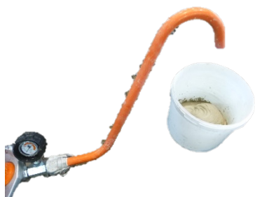
Ábra 56: Állagellenőrző cső
