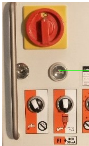
Ábra 44: A keverőzóna vízzel való feltöltése
