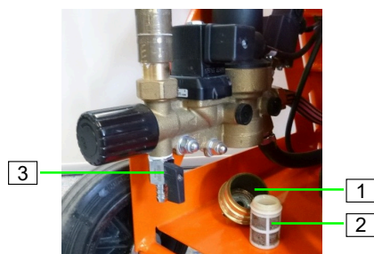
Ábra 36: A szennyfogó szita ellenőrzése
