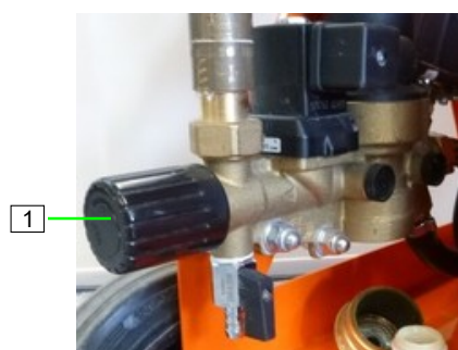
Ábra 99: Nyomáscsökkentő szelep
