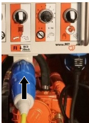
Ábra 33: Áramellátás csatlakoztatása
