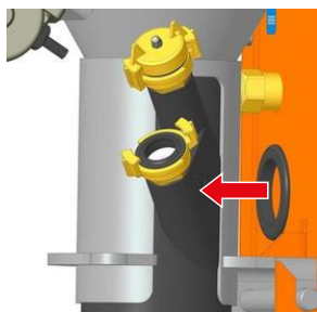
Ábra 89: A gumi keverőzóna illeszkedése
