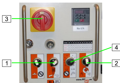
Ábra 72: A gép bekapcsolása áramkimaradás után
