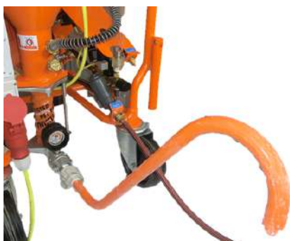
Figura 57: Țeavă de verificare a consistenței
