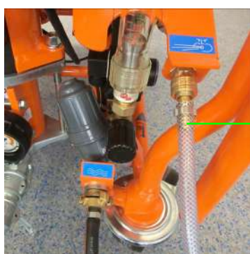
Figura 48: Racordarea furtunului de aer
