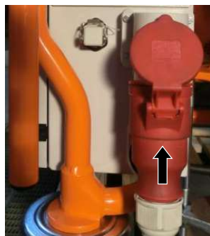
Figura 34: Racordați tensiunea de alimentare
