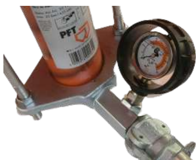
Figura 16: Manometru presiune mortar
