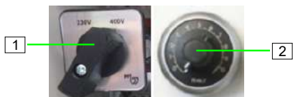
Figura 30: Comutarea tensiunii
