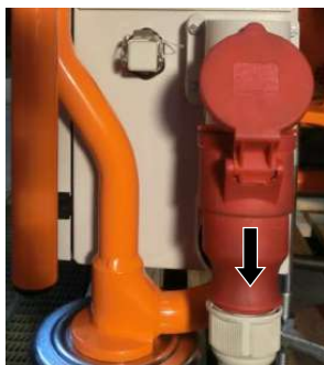
Figura 95: Îndepărtați cablul de conexiune
