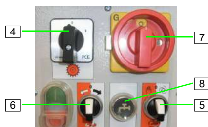
Figura 74: Suflarea pentru uscare a armăturii apei
