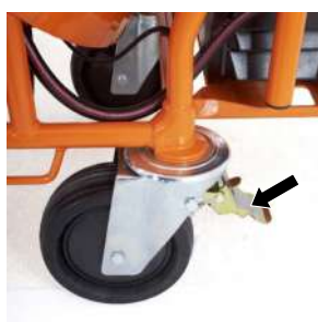
Figura 29: Blocați rola de fixare
