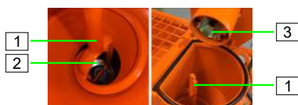
Figura 84: Montarea axului de amestecare
