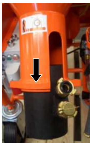
Figura 87: Curățarea zonei de amestecare din cauciuc
