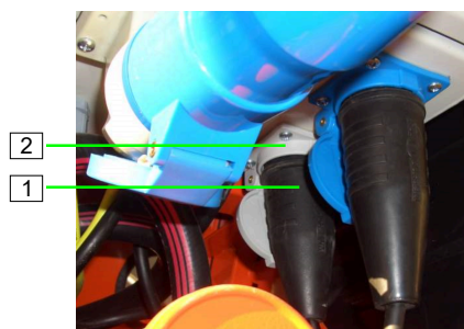
Figura 50: Conectarea vibratorului
