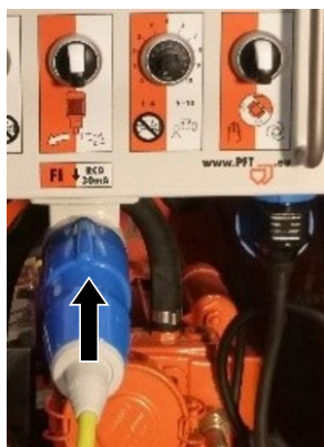
Figura 32: Racordarea tensiunii de alimentare
