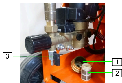
Figura 34: Verificarea sitei de reținere a impurităților
