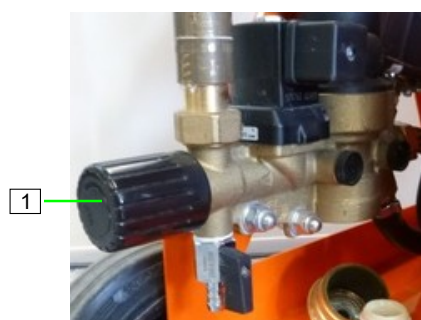
Figura 98: Supapă de reducere a presiunii
