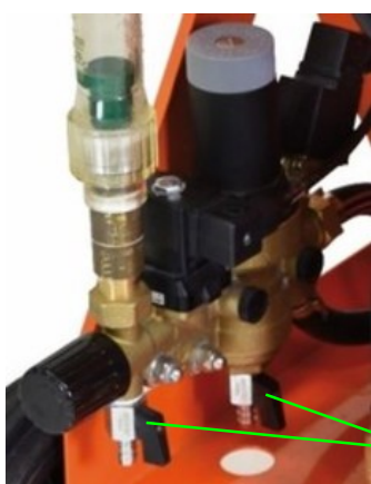
Figura 72: Deschiderea robinetelor de evacuare
