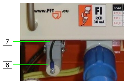
Figura 48: Conectarea cablului de telecomandă
