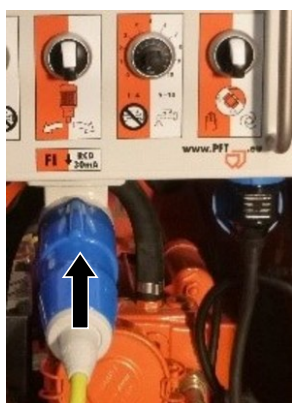
Afbeelding 36: Stroomvoorziening aansluiten
