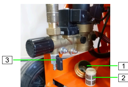
Afbeelding 39: Vuilvangzeef controleren
