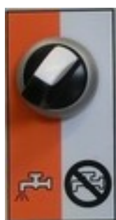
Afbeelding 22: Selectieschakelaar water
