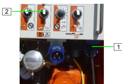
Afbeelding 37: Pompmotor uitschakelen
