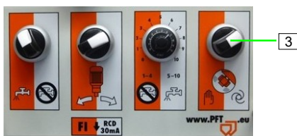
Afbeelding 55: Schudder inschakelen
