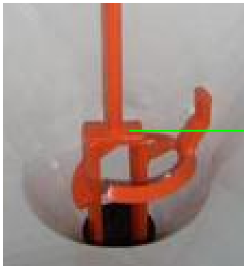
Abb. 77: Mischwendel entnehmen
