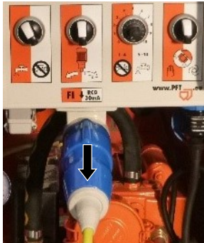
Abb. 100: Anschlusskabel entfernen
