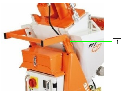
Abb. 7: Drehriegel öffnen
