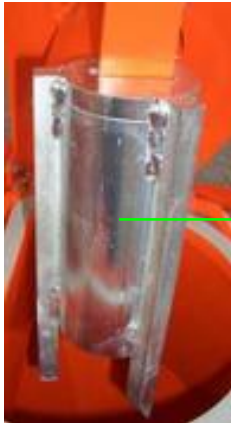
Abb. 87: Mischrohrreiniger einsetzen
