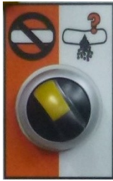
Abb. 23: Wahlschalter Füllstandsonde
