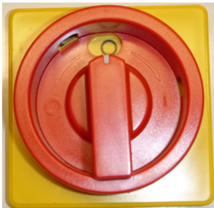
Abb. 73: Hauptschalter auf Stellung "0"
