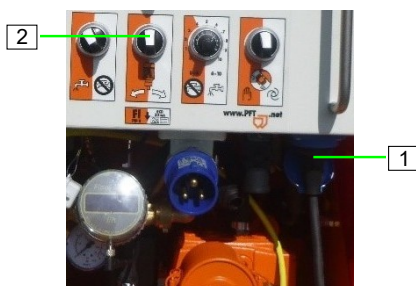
Abb. 37: Pumpenmotor ausschalten
